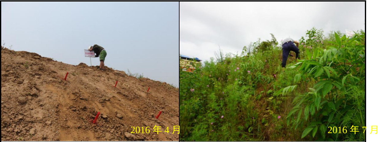
1#监测点布置——表土堆场侵蚀钉
